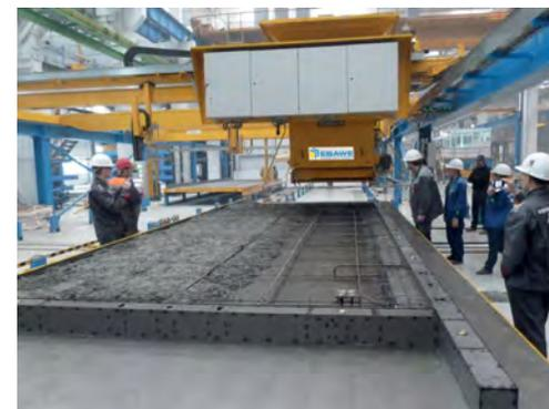
*Бетонирование сплошных стеновых панелей.*
