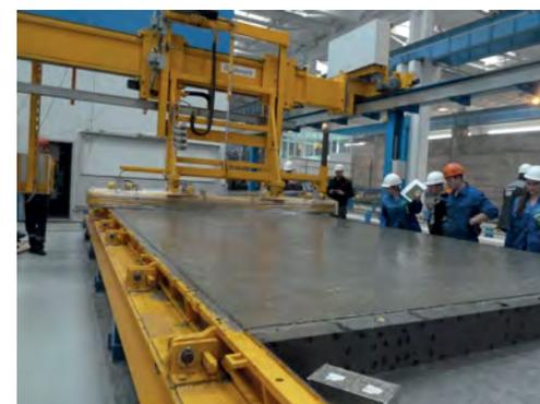
*Заглаживающая платформа для выравнивания залитой бетонной смеси.*
